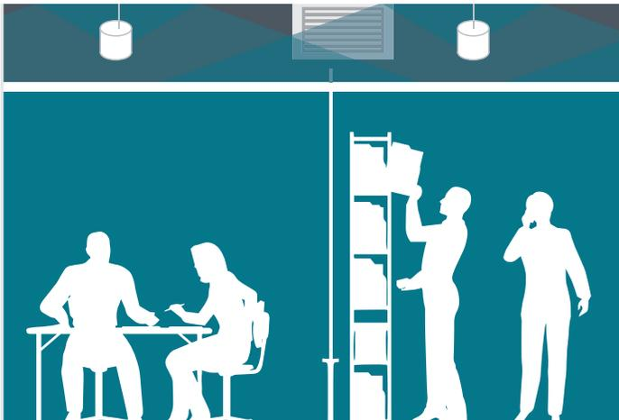
El enmascaramiento acústico indirecto utiliza altavoces que disparan hacia arriba para emitir la salida del enmascaramiento acústico contra la cubierta del techo, donde se refleja hacia abajo en el entorno deseado.
