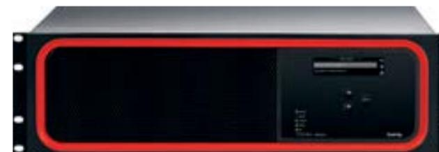
El SERVER-IO de Tesira es un servidor de red digital, configurado de fábrica con una tarjeta DSP-2 y capaz de manejar hasta dos tarjetas DSP-2 adicionales. El SERVER-IO tiene capacidad para un total de hasta tres tarjetas de red de audio por servidor.
