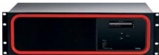
El SERVER de Tesira es un servidor de red digital, configurado de fábrica con una tarjeta DSP-2 capaz de aceptar hasta ocho tarjetas DSP-2 y una tarjeta AVB-1. Además, SERVER está equipado con una segunda ranura que puede equiparse con una tarjeta AVB-1 adicional, una tarjeta SCM-1 CobraNet de 32 x 32 canales, una tarjeta DAN-1 Dante de 64 x 64 canales o una tarjeta de E/S estándar para cuatro canales de E/S locales.
